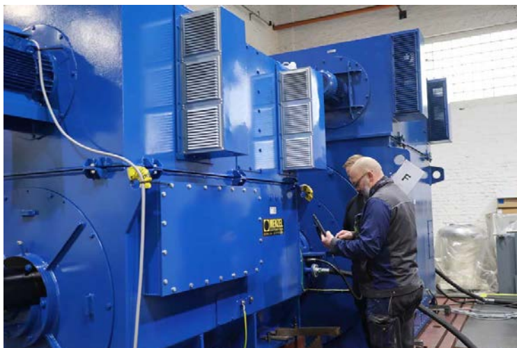
Bild: Menzel fertigte den Motor und Generator und projektierte den kompletten Umformersatz zum Messen und Prüfen von Leistungstransformatoren
